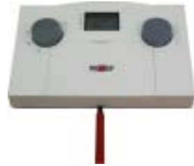
Demontage des ART vom Sockel mittels Schraubendreher
